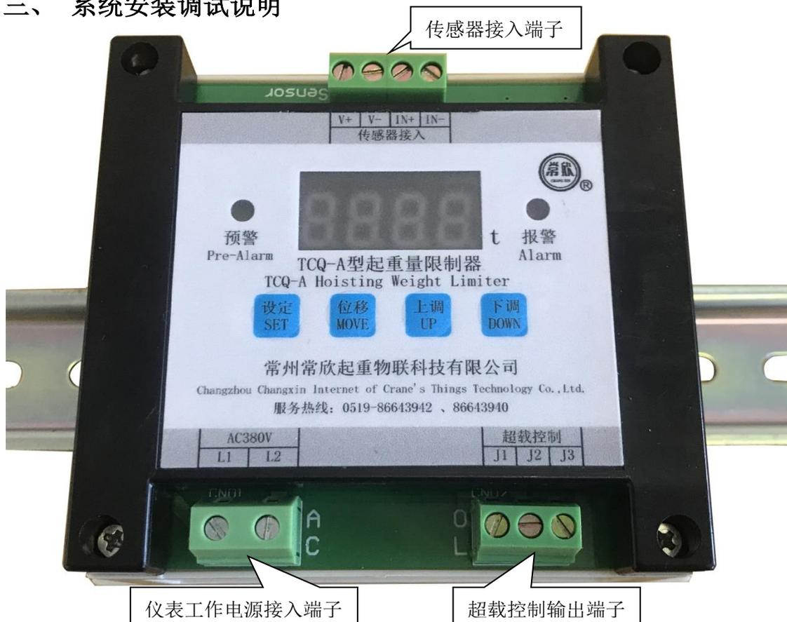
(一)、将传感器和控制仪表安装在规定位置后，用“一”字螺丝刀将传感器的出线按照（红→V+、黑→V-、黄→IN+、蓝→IN-）和控制仪表传感器接入端子上的标志对应连接起来，另外传感器出线的屏蔽网接仪表安装螺丝上。
